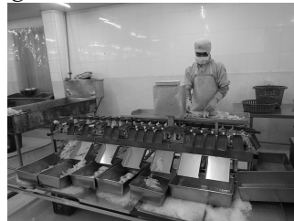
Băng chuyên công nghệ phân size hải sản của Baseafood 1 (TP. Bà Rịa) được đầu tư từ Quỹ KH-CN doanh nghiệp.
